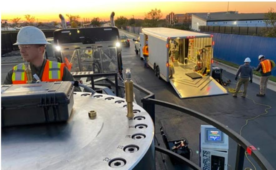
Paquete 380B Tipo B sometido a una prueba de estanqueidad previa al envío.
